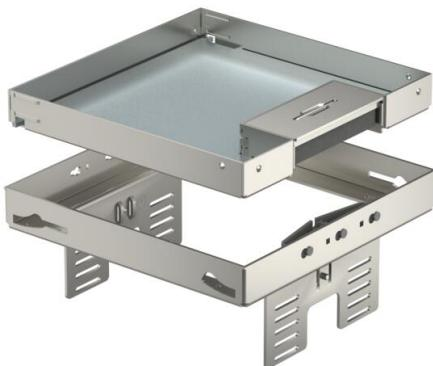
Caja nivelable y desacoplada del suelo del tamaño nominal 4, con salida de cable, para el montaje de sistemas de instalación en suelos que requieren limpieza en seco en zonas interiores, para el montaje en cajas bajo suelo UZD250 o UZD350, cada una en combinación con una tapa de montaje DUG./.4 o en UGD250-3/4 o UGD350-3/4. El montaje se efectúa mediante un ángulo de nivelación (pedir por separado) en el perfil del marco de aluminio de las cajas bajo suelo.
