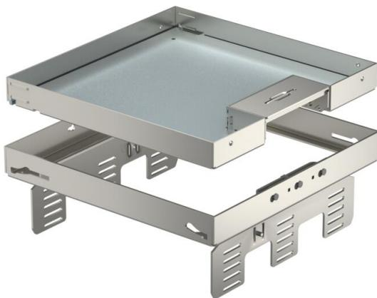
Caja de nivelación de tamaño nominal 9, desacoplado del suelo, con salida de cable, para el montaje de dispositivos de instalación en suelos limpiados en seco en interiores, para montaje en cajas bajo suelo UZD250 o UZD350, en cada caso en combinación con una tapa de montaje DUG./9 o en UGD250-3/9 o UGD350-3/9. S:0 El montaje se efectúa mediante un ángulo de nivelación (pedir por separado) en el perfil del marco de aluminio de las cajas bajo suelo.
