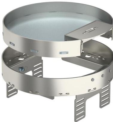
Conjunto de tapa y marco de altura regulable y desacoplada del suelo de tamaño nominal 4, con salida de cable, para el montaje de mecanismos en pavimentos que precisan limpieza en seco, para montar en cajas bajo suelo UZD250-3 o UZD350-3, en combinación con una tapa de montaje DUG..R4 o en UGD250-3R4 o UGD350-3R4. El montaje se efectúa mediante ángulos de nivelación (pedir por separado) en el perfil del marco de aluminio de las cajas bajo suelo.
