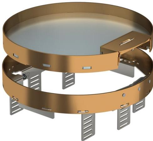
Conjunto de tapa y marco de altura regulable y desacoplada del suelo de tamaño nominal R7, con salida de cable, para el montaje de mecanismos en pavimentos que precisan limpieza en seco, para montar en cajas bajo suelo UZD350-3 en combinación con una tapa de montaje DUG350-3R7 o en UGD350-3R7. El montaje se efectúa mediante ángulos de nivelación (pedir por separado) en el perfil del marco de aluminio de las cajas bajo suelo.
