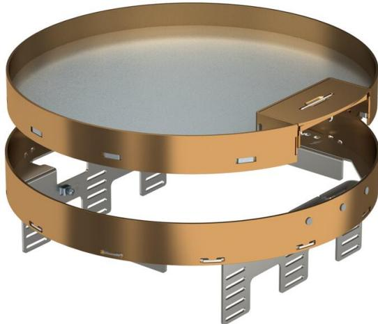
Conjunto de tapa y marco de altura regulable y desacoplada del suelo de tamaño nominal R7, con salida de cable, para el montaje de mecanismos en pavimentos que precisan limpieza en seco, para montar en cajas bajo suelo UZD350-3 en combinación con una tapa de montaje DUG350-3R7 o en UGD350-3R7. El montaje se efectúa mediante ángulos de nivelación (pedir por separado) en el perfil del marco de aluminio de las cajas bajo suelo.
