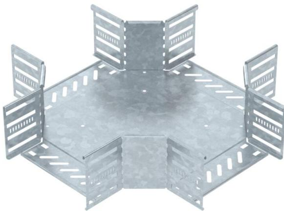
Cruce para establecer una derivación horizontal, accesorio para bandejas portacables encajables y atornillables con ala de 110 mm. Montaje sin tornillos con abrazaderas dobles o unión atornillada con tornillos redondos planos FRS y tuercas combinadas M6. De uso en interiores y exteriores. El material de fijación se debe pedir por separado.
