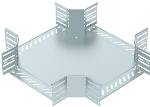
Cruce para establecer una derivación horizontal, accesorio para bandejas portacables encajables y atornillables con ala de 110 mm. Montaje sin tornillos con abrazaderas dobles o unión atornillada con tornillos redondos planos FRS y tuercas combinadas M6. De uso en espacio interior. El material de fijación se debe pedir por separado.
