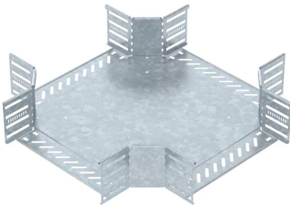
Cruce para establecer una derivación horizontal, accesorio para bandejas portacables encajables y atornillables con ala de 110 mm. Montaje sin tornillos con abrazaderas dobles o unión atornillada con tornillos redondos planos FRS y tuercas combinadas M6. De uso en interiores y exteriores. El material de fijación se debe pedir por separado.
