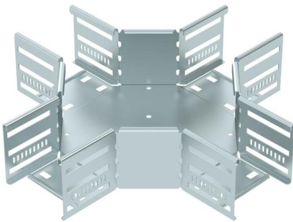
Cruce para establecer una derivación horizontal, accesorio para bandejas portacables encajables y atornillables con ala de 85 mm. Montaje sin tornillos con abrazaderas dobles o unión atornillada con tornillos redondos planos FRS y tuercas combinadas M6. De uso en espacio interior. El material de fijación se debe pedir por separado.
