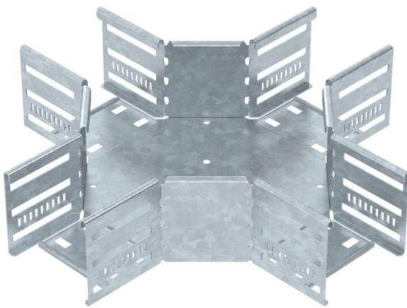
Cruce para establecer una derivación horizontal, accesorio para bandejas portacables encajables y atornillables con ala de 85 mm. Montaje sin tornillos con abrazaderas dobles o unión atornillada con tornillos redondos planos FRS y tuercas combinadas M6. De uso en interiores y exteriores. El material de fijación se debe pedir por separado.
