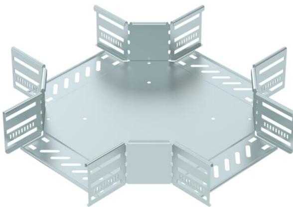
Cruce para establecer una derivación horizontal, accesorio para bandejas portacables encajables y atornillables con ala de 85 mm. Montaje sin tornillos con abrazaderas dobles o unión atornillada con tornillos redondos planos FRS y tuercas combinadas M6. De uso en espacio interior. El material de fijación se debe pedir por separado.
