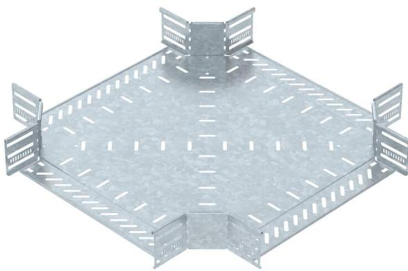
Cruce para establecer una derivación horizontal, accesorio para bandejas portacables encajables y atornillables con ala de 85 mm. Montaje sin tornillos con abrazaderas dobles o unión atornillada con tornillos redondos planos FRS y tuercas combinadas M6. De uso en interiores y exteriores. El material de fijación se debe pedir por separado.
