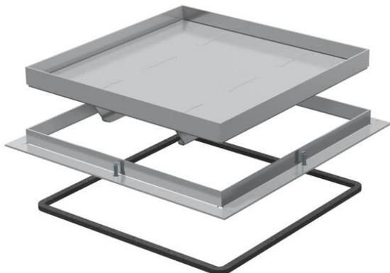
Tapa ciega y marco para cargas pesadas que permite practicar una abertura de revisión en la caja UZD250-3 en pavimentos que precisan una limpieza en seco o con agua. Clase de carga 2 hasta 20 kN. Sólo son apropiados para pavimentos pulidos.
