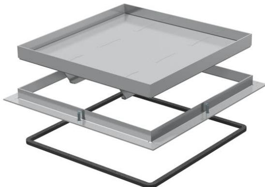
Tapa ciega y marco para cargas pesadas que permite practicar una abertura de revisión en la caja UZD350-3 en pavimentos que precisan una limpieza en seco o con agua. Clase de carga 2 hasta 20 kN. Sólo son apropiados para pavimentos pulidos.
