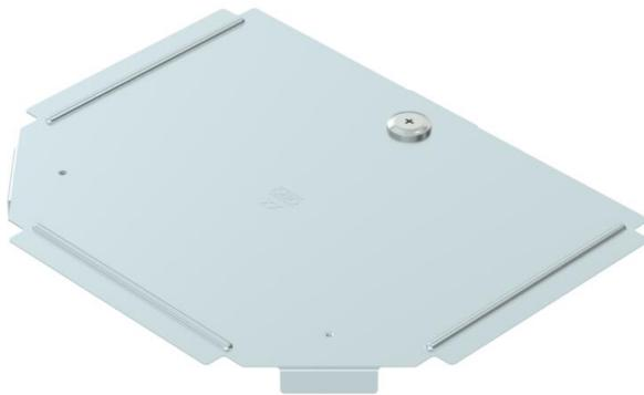
Tapa para pieza moldeada de pieza en T para bandejas portacables encajables y atornillables en interiores, para proteger los cables frente a daños y suciedad. Sujeción mediante pestillo giratorio premontado y fijación mediante apoyo de la tapa de tramo. Apto para todas las alturas de ala
