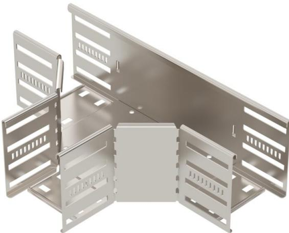
Pieza en T para establecer una derivación horizontal, accesorio para bandejas portacables encajables y atornillables con ala de 110 mm. Montaje sin tornillos con abrazaderas dobles o unión atornillada con tornillos redondos planos FRS y tuercas combinadas M6. De uso en interiores y exteriores. El material de fijación se debe pedir por separado.
