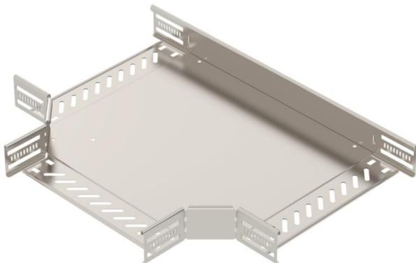
Pieza en T para establecer una derivación horizontal, accesorio para bandejas portacables encajables y atornillables con ala de 60 mm. Montaje sin tornillos con abrazaderas dobles o unión atornillada con tornillos redondos planos FRS y tuercas combinadas M6. De uso en interiores y exteriores. El material de fijación se debe pedir por separado.
