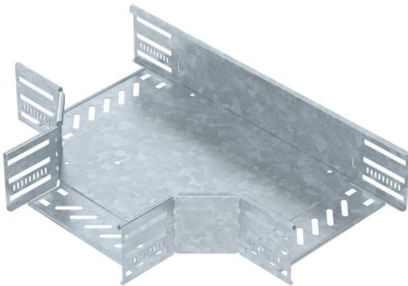
Pieza en T para establecer una derivación horizontal, accesorio para bandejas portacables encajables y atornillables con ala de 85 mm. Montaje sin tornillos con abrazaderas dobles o unión atornillada con tornillos redondos planos FRS y tuercas combinadas M6. De uso en interiores y exteriores. El material de fijación se debe pedir por separado.
