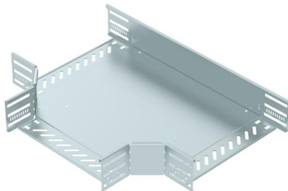
Pieza en T para establecer una derivación horizontal, accesorio para bandejas portacables encajables y atornillables con ala de 85 mm. Montaje sin tornillos con abrazaderas dobles o unión atornillada con tornillos redondos planos FRS y tuercas combinadas M6. De uso en espacio interior. El material de fijación se debe pedir por separado.
