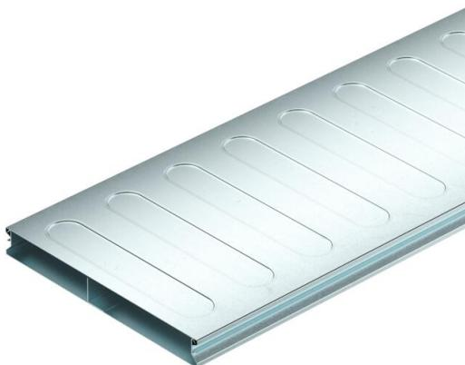
Canal para suelo (2 piezas) para el tendido de cables y líneas en sistemas bajo suelo con revestimiento de solado según la norma EN 50085-2-2. Tapa del canal desmontable y de encaje continuo. Con tabique separador en la parte inferior del canal. Máxima capacidad de carga hasta 1,5 kN.
