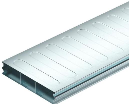
Canal para suelo (2 piezas) para el tendido de cables y líneas en sistemas bajo suelo con revestimiento de solado según la norma EN 50085-2-2. Tapa del canal desmontable y de encaje continuo. Con tabique separador en la parte inferior del canal. Máxima capacidad de carga hasta 1,5 kN.
