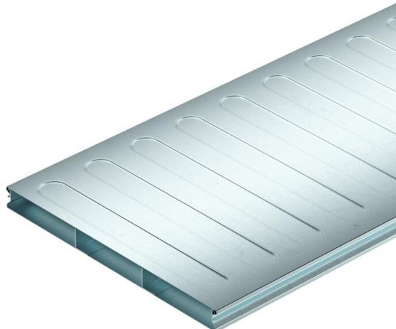
Canal para suelo (2 piezas) para el tendido de cables y líneas en sistemas bajo suelo con revestimiento de solado según la norma EN 50085-2-2. Tapa del canal desmontable y de encaje continuo. Con tabique separador en la parte inferior del canal. Máxima capacidad de carga hasta 1,5 kN. Las paredes laterales perfiladas ofrecen una función de enganche para encajar la tapa del canal en la base del mismo. Los cordones de refuerzo de la tapa del canal refuerzan su estabilidad.
