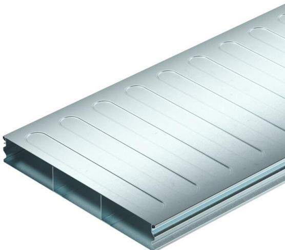
Canal para suelo (2 piezas) para el tendido de cables y líneas en sistemas bajo suelo con revestimiento de solado según la norma EN 50085-2-2. Tapa del canal desmontable y de encaje continuo. Con tabique separador en la parte inferior del canal. Máxima capacidad de carga hasta 1,5 kN. Las paredes laterales perfiladas ofrecen una función de enganche para encajar la tapa del canal en la base del mismo. Los cordones de refuerzo de la tapa del canal refuerzan su estabilidad.
