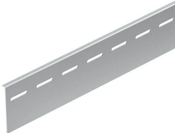
Chapa protectora para colocación lateral como protección sincronizada para el sistema de bandejas portacables transitables. La chapa protectora se puede instalar en los apoyos en Z con los tornillos de chapa de cabeza rebajada del tipo SPHS.
