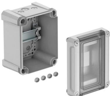
Distribuidor pequeño para el montaje empotrado, para subdistribución de corriente en interiores y exteriores, según IEC 439-3. Con carril en U premontado de 35 mm. Clase de protección IP66 y grado de protección IK08 Tapa transparente para atornillar, con sección. Incluidos 4 tapones roscados.
