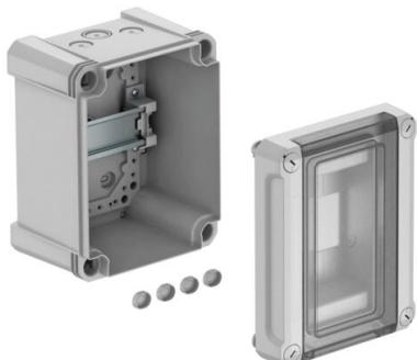
Distribuidor pequeño para el montaje empotrado, para subdistribución de corriente en interiores y exteriores protegidos, según IEC 439-3. Con carril en U pre-montado de 35 mm. Clase de protección IP66 y grado de protección IK07. Tapa transparente para atornillar, con sección.
