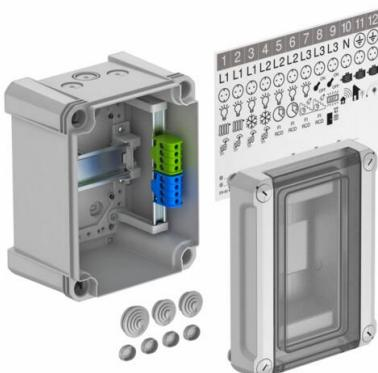
Distribuidor pequeño con regleta de bornes para el montaje empotrado, para subdistribución de corriente en interiores y exteriores protegidos, según IEC 439-3. Con carril en U premontado de 35 mm. Clase de protección IP66 y grado de protección IK07. Tapa transparente para atornillar, con sección.
