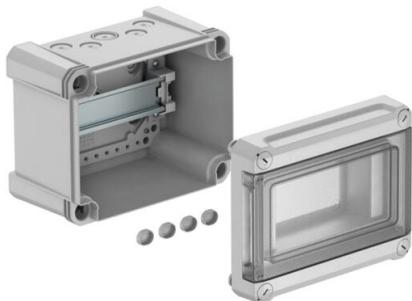
Distribuidor pequeño con regleta de bornes para el montaje empotrado, para subdistribución de corriente en interiores y exteriores, según IEC 439-3. Con carril en U premontado de 35 mm. Clase de protección IP66 y grado de protección IK08 Tapa transparente para atornillar, con sección. Incluidos 4 tapones rosados.
