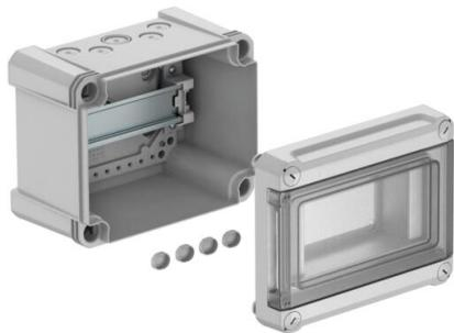
Distribuidor pequeño para el montaje empotrado, para subdistribución de corriente en interiores y exteriores protegidos, según IEC 439-3. Con carril en U pre-montado de 35 mm. Clase de protección IP66 y grado de protección IK07. Tapa transparente para atornillar, con sección.
