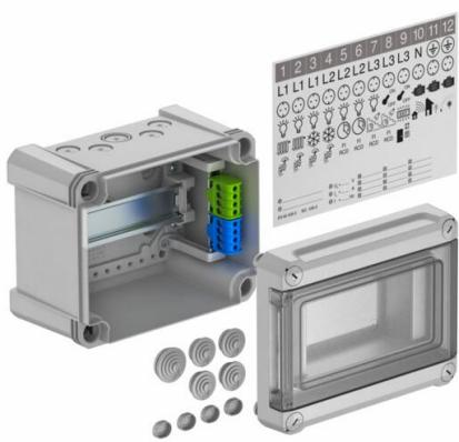
Distribuidor pequeño con regleta de bornes para el montaje empotrado, para subdistribución de corriente en interiores y exteriores protegidos, según IEC 439-3. Con carril en U premontado de 35 mm. Clase de protección IP66 y grado de protección IK07. Tapa transparente para atornillar, con sección.
