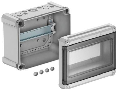
Distribuidor pequeño para el montaje empotrado, para subdistribución de corriente en interiores y exteriores, según IEC 439-3. Con carril en U premontado de 35 mm. Clase de protección IP66 y grado de protección IK08 Tapa transparente para atornillar, con sección. Incluidos 4 tapones rosados.
