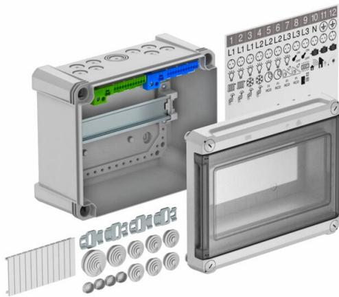
Distribuidor pequeño con regleta de bornes para el montaje empotrado, para subdistribución de corriente en interiores y exteriores, según IEC 439-3. Con carril en U premontado de 35 mm. Clase de protección IP66 y grado de protección IK08 Tapa transparente para atornillar, con sección.
