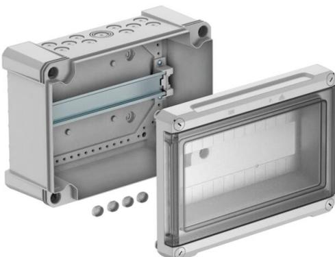
Distribuidor pequeño para el montaje empotrado, para subdistribución de corriente en interiores y exteriores, según IEC 439-3. Con carril en U premontado de 35 mm. Clase de protección IP66 y grado de protección IK08 Tapa transparente para atornillar, con sección. Incluidos 4 tapones roscados.
