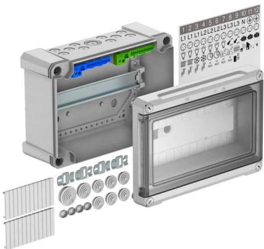
Distribuidor pequeño con regleta de bornes para el montaje empotrado, para subdistribución de corriente en interiores y exteriores, según IEC 439-3. Con carril en U premontado de 35 mm. Clase de protección IP66 y grado de protección IK08 Tapa transparente para atornillar, con sección.
