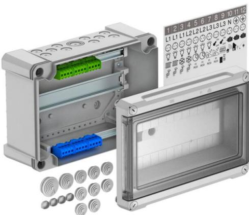
Distribuidor pequeño con regleta de bornes para el montaje empotrado, para subdistribución de corriente en interiores y exteriores protegidos, según IEC 439-3. Con carril en U premontado de 35 mm. Clase de protección IP66 y grado de protección IK07. Tapa transparente para atornillar, con sección.
