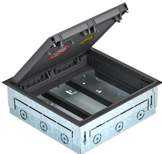
Caja cuadrada con unidad portamecanismos GES9 UGE para el uso en suelos pavimentados. Con entradas pretrouqueladas para la introducción de las canalizaciones (M20/M25) desde los cuatro lados.
