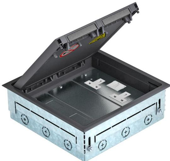
Caja cuadrada con unidad portamecanismos GES9 UGE para el montaje en pavimentos en zonas interiores. Con entradas pretrouqueladas para la introducción de las canalizaciones (M25) desde los cuatro lados. En el volumen se incluye un tapa APMT5 ciega y una tapa para 4 conexiones de datos del tipo LUJ6C y 1 tapa APMT5 conectada con toma doble. La profundidad mínima de instalación es de 64 mm, el rango de nivelación + 23 mm.
