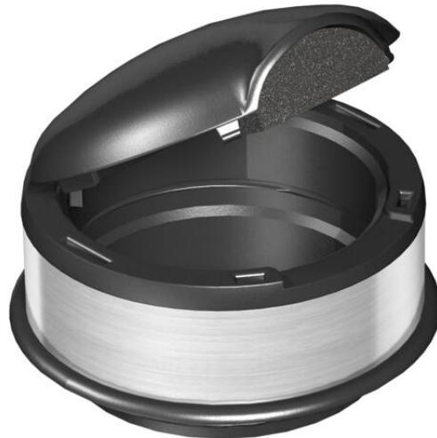
Tapa de protección para cajas UDL2-80 y salidas de canal, para proteger la salida de los cables en pavimentos de limpieza con agua con anillo ranurado reforzado de poliamida, que está revestido con un anillo de V2A, y junta de goma.
