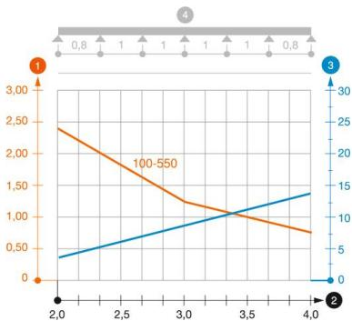
Diagrama de carga bandeja de chapa ciega SKSU 110
