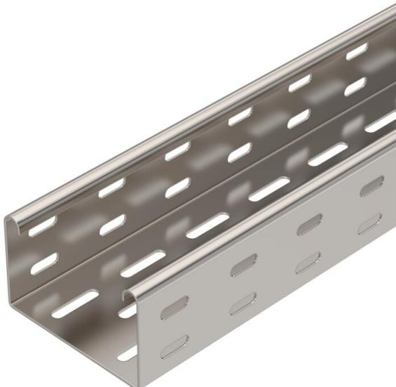
SKS 60 = sistema de bandeja portacables de ala 60 mm. La bandeja portacables SKS puede utilizarse también para mantener la integridad funcional. Para otras características, véase los sistemas de protección contra incendios BSS. La bandeja portacables se fija en la escuadra con tornillos tipo FRS M6 x 12.
