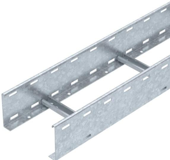
Bandeja de escalera de ala 110 mm con peldaños de perfil en C30 soldados, abiertos hacia arriba. Barra lateral enrollada como refuerzo y como protección de bordes. La fijación en la escuadra se realiza con bridas de fijación LKS 40. La medida de la ranura del peldaño es de 16,5 mm; la abrazadera de media caña sobre perfil adecuada es 2056. Aislamiento magnético sin tapa 10 dB, con tapa 15 dB.
