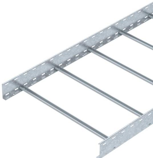
Bandeja de escalera con ala de 110 mm con peldaños de perfil C30 soldados, abiertos hacia arriba. Barra lateral enrollada como refuerzo y como protección de bordes. La fijación en la escuadra se realiza con bridas de fijación LKS 40. La medida de la ranura del peldaño es de 16,5 mm; la abrazadera de media caña sobre perfil adecuada es 2056. Aislamiento magnético sin tapa 10 dB, con tapa 15 dB.
