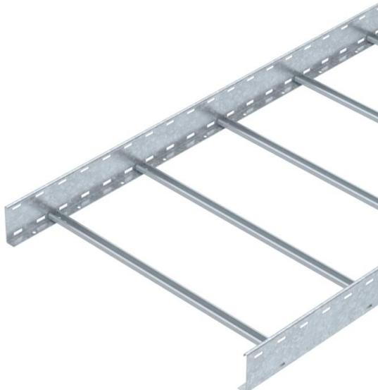
Bandeja de escalera de ala 110 mm con peldaños de perfil en C30 soldados, abiertos hacia arriba. Barra lateral enrollada como refuerzo y como protección de bordes. La fijación en la escuadra se realiza con bridas de fijación LKS 40. La medida de la ranura del peldaño es de 16,5 mm; la abrazadera de media caña sobre perfil adecuada es 2056. Aislamiento magnético sin tapa 10 dB, con tapa 15 dB.
