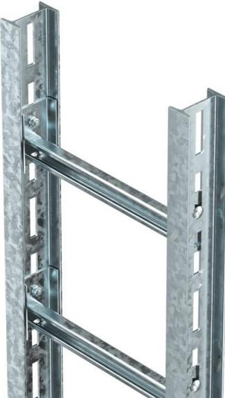
Sistema de bandejas de escalera de uso industrial para el mantenimiento de función eléctrica según DIN 4102, parte 12. Bridas homologadas tipo BS-U1-M... FT. Los artículos se suministran desmontados. Distancia entre peldaños de 300 mm. Los peldaños tipo CK 40/... y los tornillos tipo FRS 10 x 25 FT para largueros se suministran desmontados.
