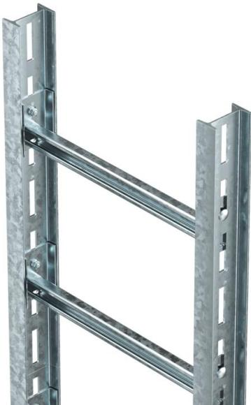
Sistema de bandejas de escalera de uso industrial para el mantenimiento de función eléctrica según DIN 4102, parte 12. Bridas homologadas tipo BS-U1-M... FT. Los artículos se suministran desmontados. Distancia entre peldaños de 300 mm. Los peldaños tipo CK 40/... y los tornillos tipo FRS 10 x 25 FT para largueros se suministran desmontados.
