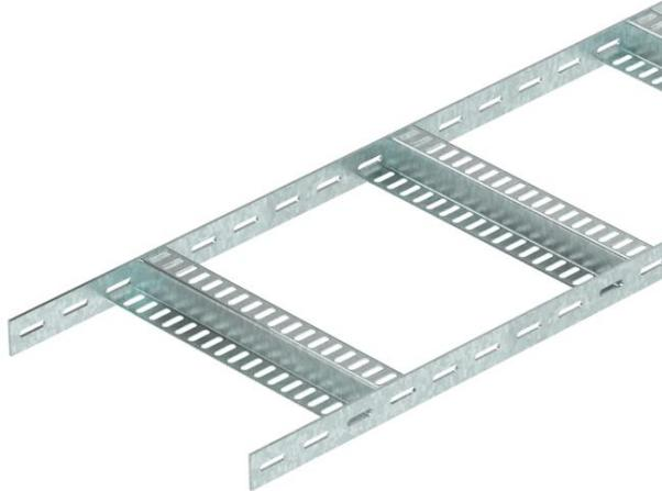
Bandeja de escalera para barcos ligera, con barra lateral perforada de ala 35 mm con peldaños en forma de Z soldados y perforados. Carga probada según CEI en combinación con conector SLV.
