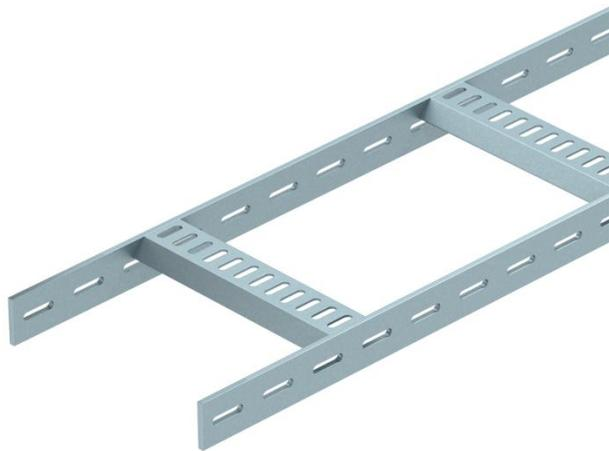
Bandeja de escalera para barcos con barra lateral perforada de ala 40 mm con peldaños trapezoidales, soldados, perforados y abiertos hacia abajo. Carga probada según CEI en combinación con conector SLV.
