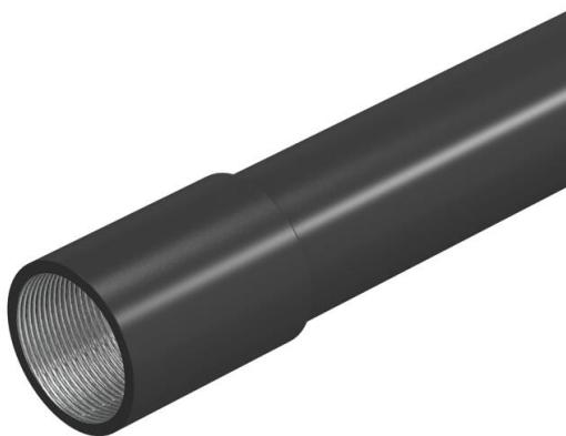
Tubo para instalaciones eléctricas según EN 61386-1, con extremos roscados según DIN EN 60423, para la protección mecánica de cables y conductores. Con pared interior sin rebabas. Clase de protección contra la corrosión 2 (media). Por cada tubo ya se ha enroscado un manguito de unión.
