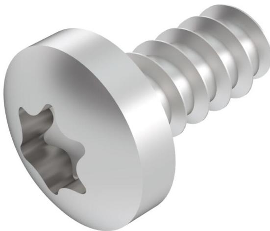
Tornillo de chapa con cabeza alomada según F y accionamiento Torx, conforme a la norma DIN EN ISO 7049, para la fijación de chapas protectoras a los apoyos en Z para el sistema de bandejas portacables transitables.
