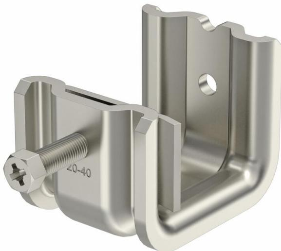
Este tipo de abrazadera de sujeción se desliza sobre el soporte y se fija al mismo, o al acero plano, mediante una cubeta de presión y un tornillo (M8). El tornillo de cabeza hexagonal tiene un ancho de llave de 10 mm. En el cuerpo de abrazadera se instalan además otras dos roscas M8 para fijar por ejemplo varillas roscadas.
